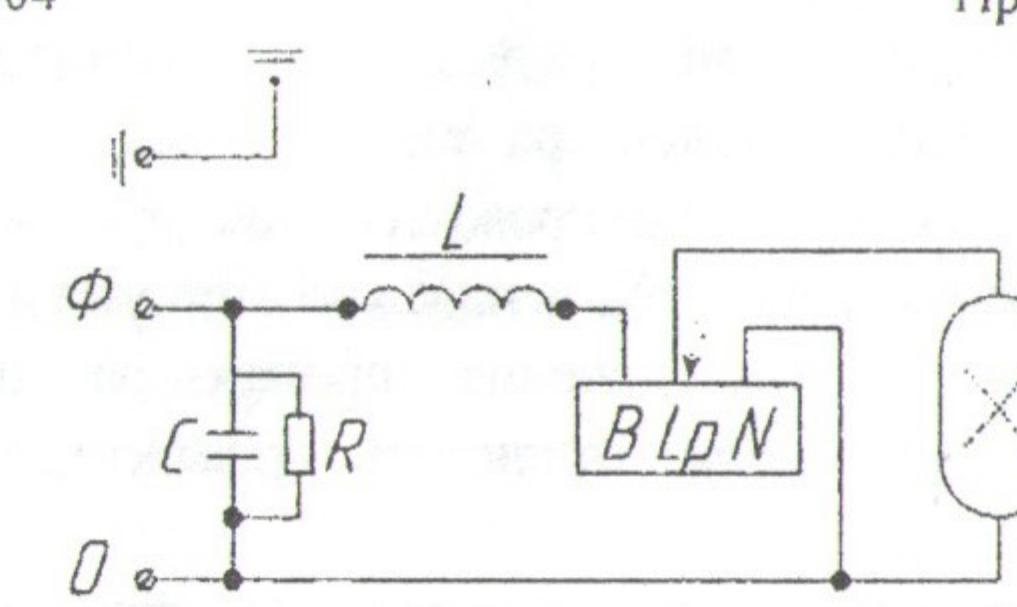
Рисунок 3 – Схема подключения для ГО04
